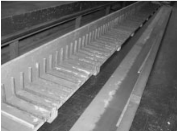
Bild 11 In der Holzschalung sind bereits Aussparungen für die Fugen des Sturzes mit einer Auskratztiefe von 15 mm berücksichtigt
