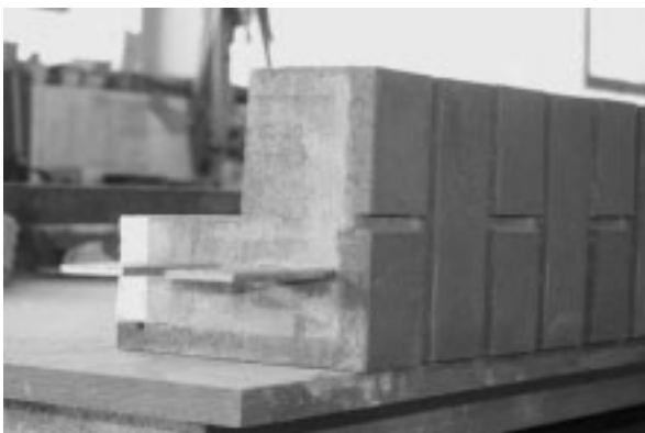
Bild 13 Ziegelfertigteilsturz für breite Leibungen mit integrierter Wärmedämmung; die Auflager bestehen aus V4A-Platten, die stirnseitig aus den Elementen hervorstehen (Röben Tonbaustoffe)
