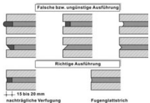
Bild 1 Zweischaliges Mauerwerk; Außenschale (Verblendschale) Fugenabschluß
