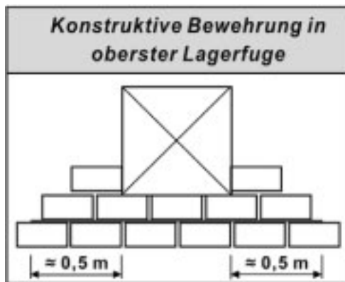
Bild 5 Außenschalen (Verblendschalen) Anordnung einer konstruktiven Bewehrung im Brüstungsbereich
