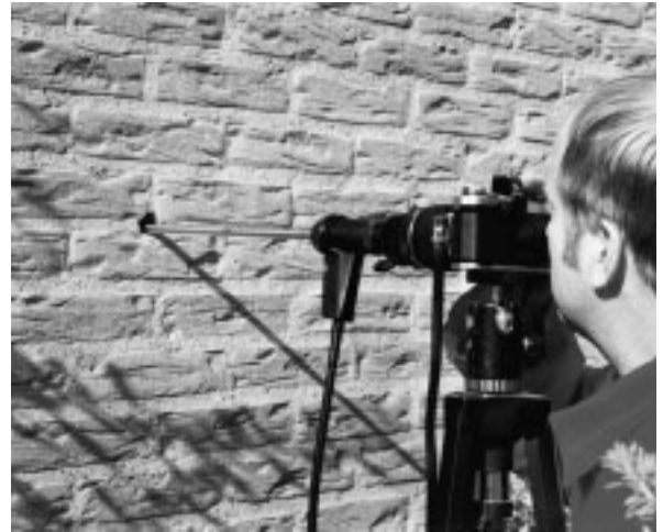
Bild 5 Untersuchung der Hohlschicht mit einem Endoskop
