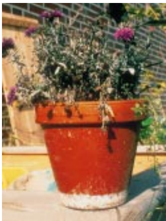
Abb. 2: Bestes Beispiel zur Veranschaulichung: Ausblühung auf dem Tontopf, entstanden durch wasserlösliche Salze aus der Blumenerde
